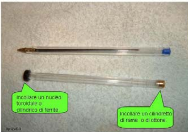
Figura 2 Realizzazione dell’utile attrezzo avvicinare la”Bacchetta magica “ alle induttanze in aria di “oggetti “ a RF accesi, per vedere l’effetto che fa.
